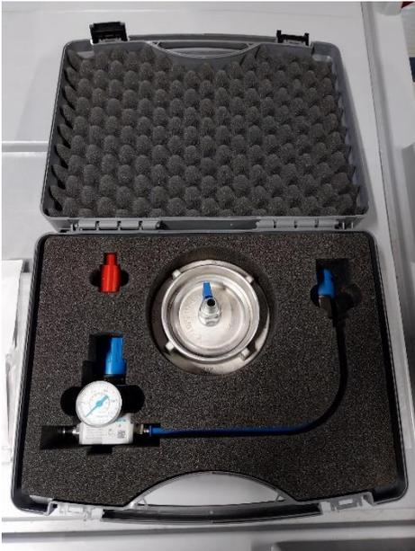
Prüfset Systemtrenner AWG
