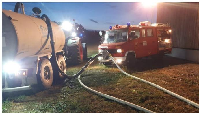
denn hier erfolgte die Wasserentnahme mittels sechs A-Saugschläuchen, die in die Befüllöffnung der Großfässer von oben eingeführt wurden. An dieser Entnahmestelle wurden insgesamt acht solcher Großfässer auf diese Weise geleert. Im weiteren Verlauf wurde auch von den Großfässern Löschwasser in die beiden faltbehälter im Innenhof des Eulenhofes übergeben.
